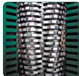
Эксклюзивно: боковые решётки для увеличения пропускной способности
